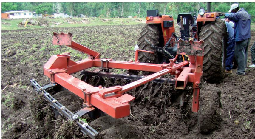
**Figura 6.** Preparo do solo na área de instalação da UD de milho na Fazenda Experimental de Fond-des-Nègres, ilustrando o "embuchamento" da grade aradora pela forte adesão da argila aos discos, e a compactação do solo devido à elevada umidade.
