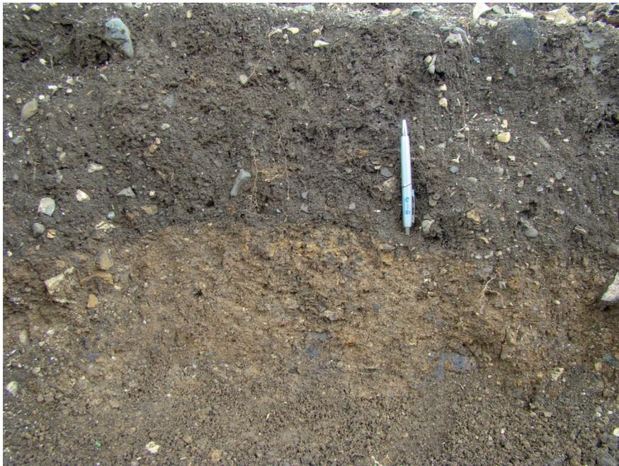
**Figura 5.** Perfil de solo na área de instalação da UD de milho na Fazenda Experimental de Fond-des-Nègres, ilustrando a mistura de materiais diferentes, saprólito e a presença de fragmentos de rocha em tamanho de cascalhos e matacões.
