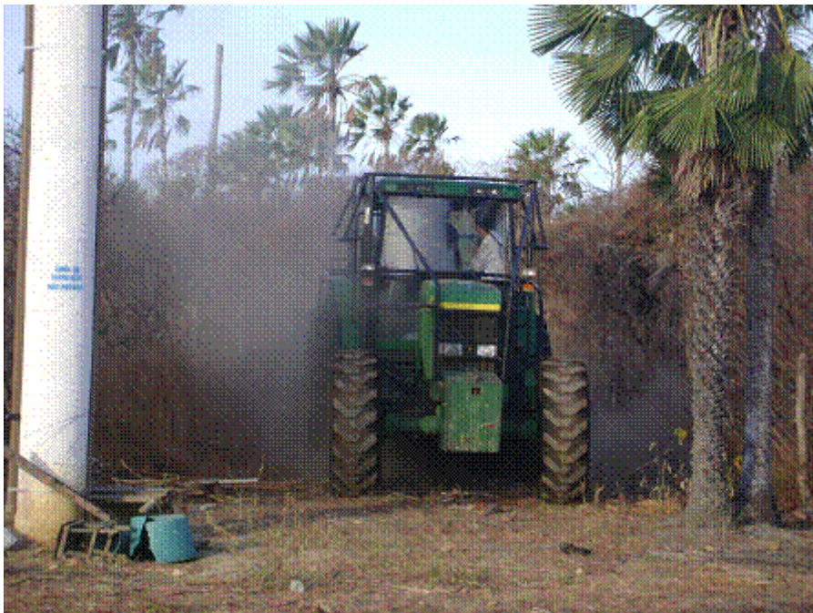
Figura 2. Equipamento Tipitamba em funcionamento para corte seletivo da caatinga.
