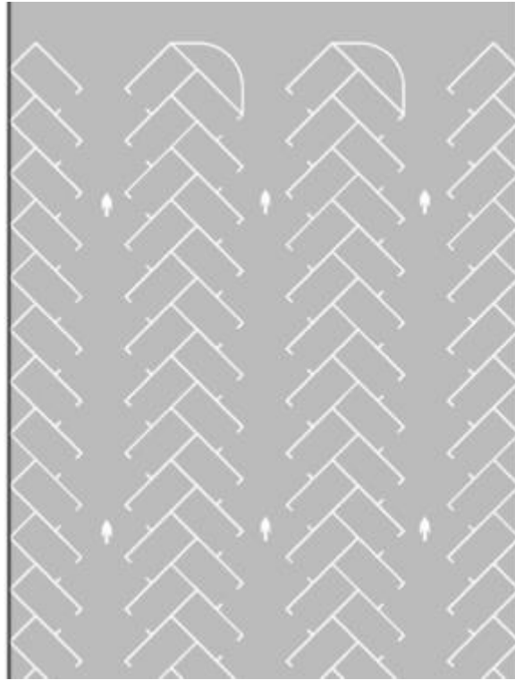
Slika 16. Parkiralište s optimalnim kosim razmještajem mjesta za parkiranje u obliku riblje kosti
