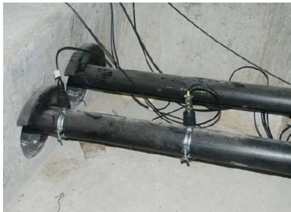
Bild 4.2: Dynamische Schwingungsmessung an einem externen Spannglied [Schö09]
