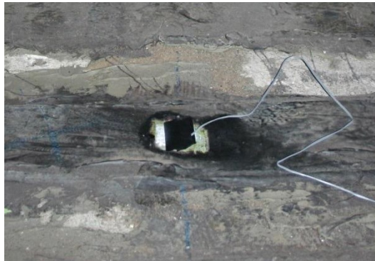
Bild 5.14: Dehnmessstreifen auf einer Stahllasche
