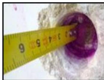
Figura 2 Prova colorimétrica para avaliar a espessura do betão afetado pelo fenómeno da carbonatação
