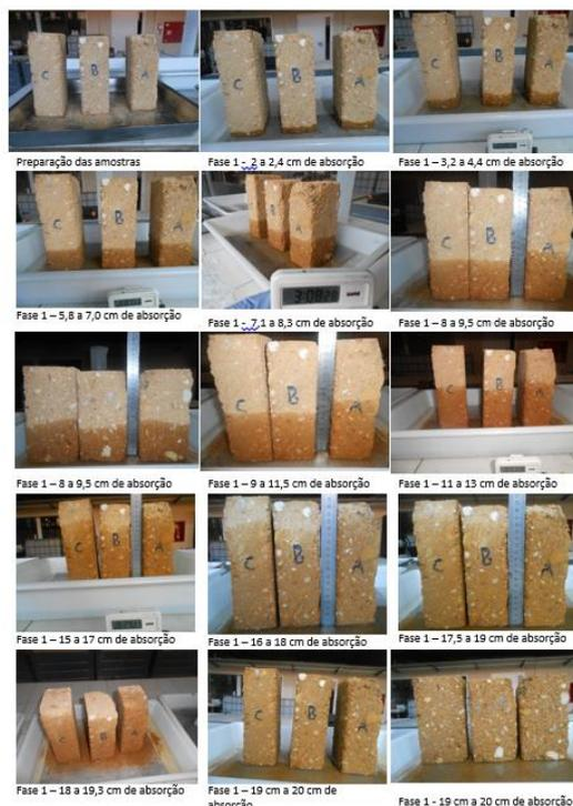
Figura 50 Imagem das amostras de adobe “aldeia nova”, com a evolução da absorção de água
