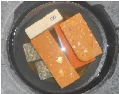
**Figura 54 Imersão dos provetes, sob pressão, por um período aproximado de 48 horas**
