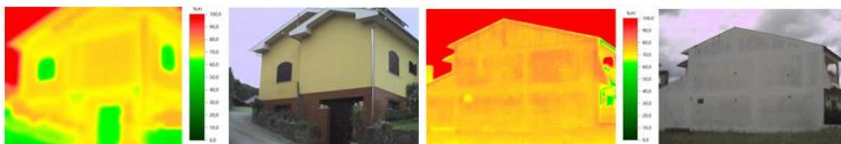
Figura 65 Detecção de elementos estruturais, inspeção diurna, IV 490 e IV 551
