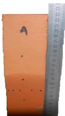
**Figura 57 Marcação dos pontos isolados no Tijolo A, comprimento total de 22,9 cm**
