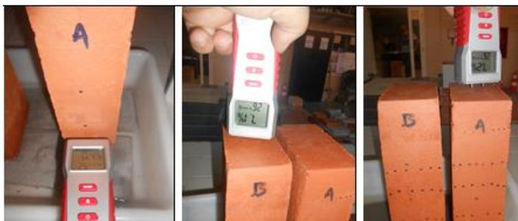
Figura 58 Monitorização da percentagem de humidade do tijolo A, B e C
