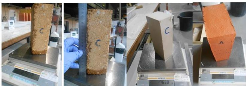
**Figura 46 Fase da pesagem e medição da absorção de água**
