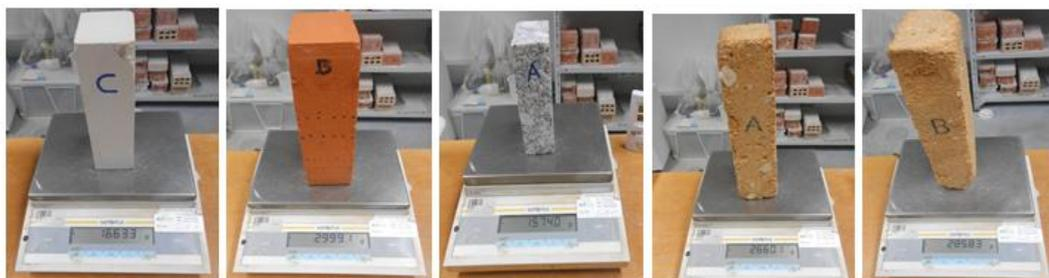
Figura 56 Pesagem dos provetes com massa estabilizada ( $m_0$ ), no interior da câmara climática
