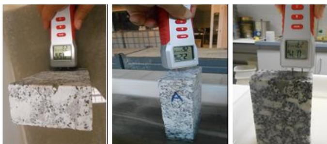
**Figura 60 Monitorização da percentagem de humidade do granito A**
