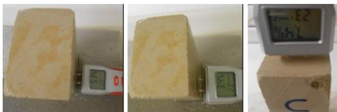
**Figura 61 Monitorização da percentagem de humidade do calcário A, B e C**
