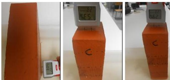
**Figura 59 Monitorização da percentagem da humidade do tijolo A, B e C, após ensaio por imersão**
