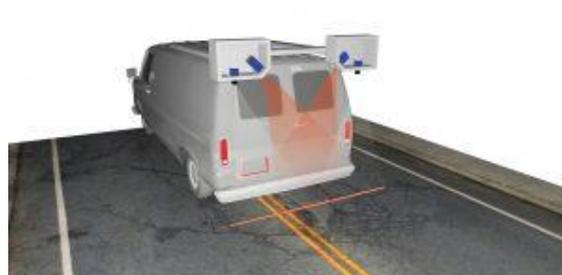
**Figura 17** Equipamento multiespectral, a aferir inspeções nas faixas rodoviárias
