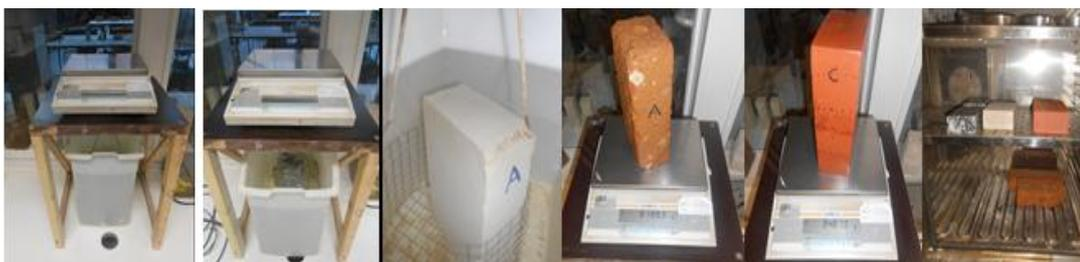
**Figura 55 Pesagem hidrostática dos provetes por imersão, posterior pesagem da massa saturada e pormenor dos provetes a secar na estufa**
