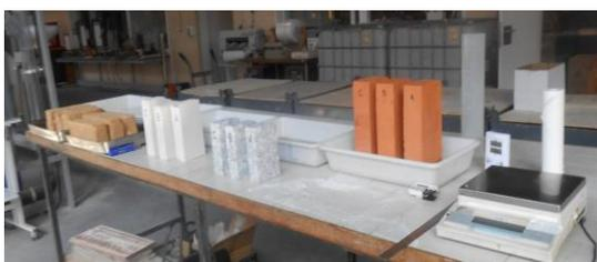
**Figura 47** Materiais utilizados no ensaio de absorção de água; tijolo, granito, calcário e adobe
