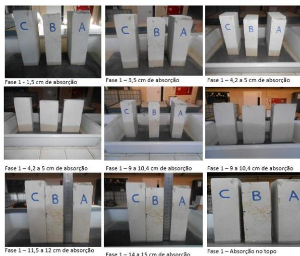
**Figura 49** Imagens das amostras de calcário, com a evolução da absorção de água
