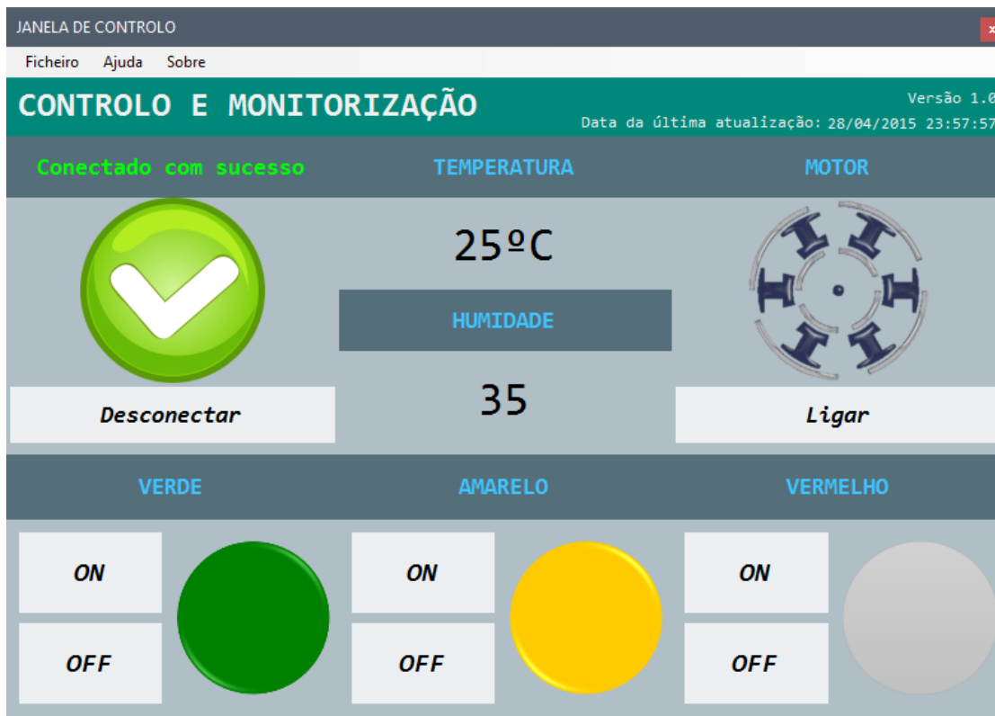
Figura 5.1: Aspeto da aplicação para controlo e monitorização de um sistema de domótica
