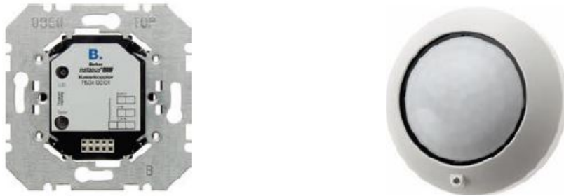
Figura 2.9: BCU à esquerda e à direita um sensor de presença usado em sistemas KNX [7]
