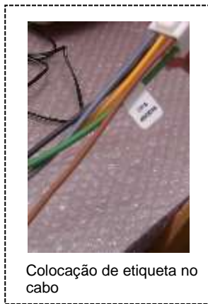
Figura 14: Operações realizadas na fase de inspeção visual e teste elétrico
