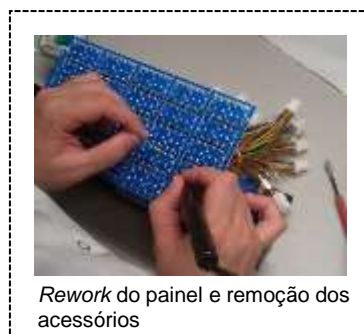
Figura 12: Operações realizadas na fase de rework
