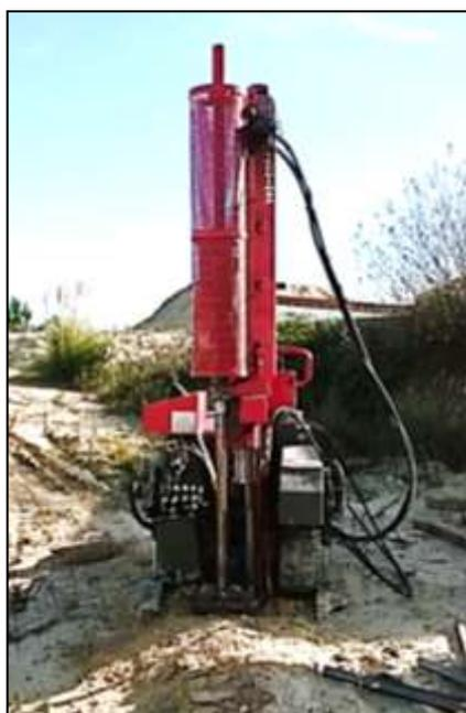
Figura 40 – Equipamento de DPSH.
