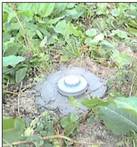
Figura 49 - Maciço em betão e tampa de proteção do piezómetro instalado na sondagem BE11.
