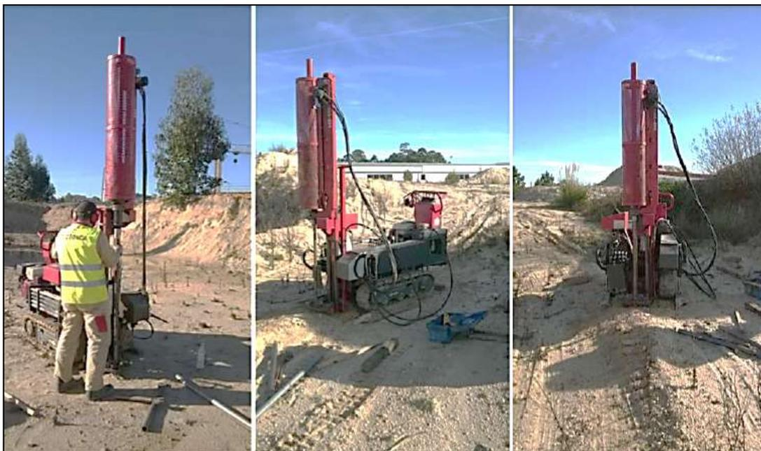
Figura 59 – Equipamento utilizado no ensaio DPSH.
