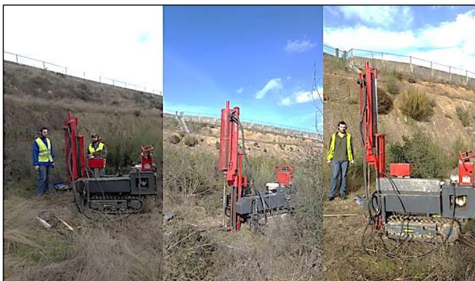
Figura 63 - Equipamento utilizado na realização dos ensaios DPSH.
