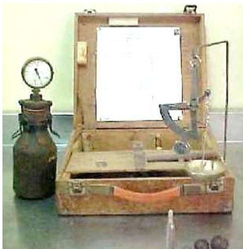
Figura 42 – Equipamento Speedy (adaptado de Carlos Palha, 2008).
