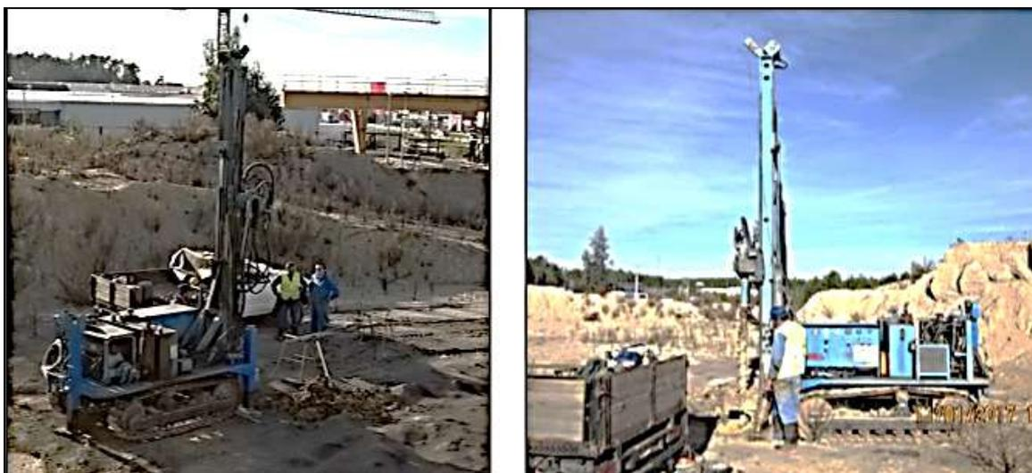
Figura 58 – Equipamento utilizado nas sondagens mecânicas.
