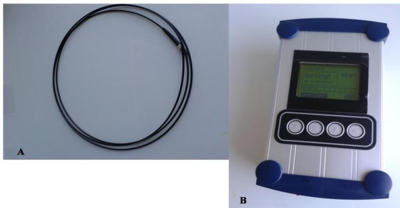
Figura 3.7 - Medidor utilizado para avaliar a entrada de oxigênio por quimioluminescência: A) fibra ótica; B) equipamento.
