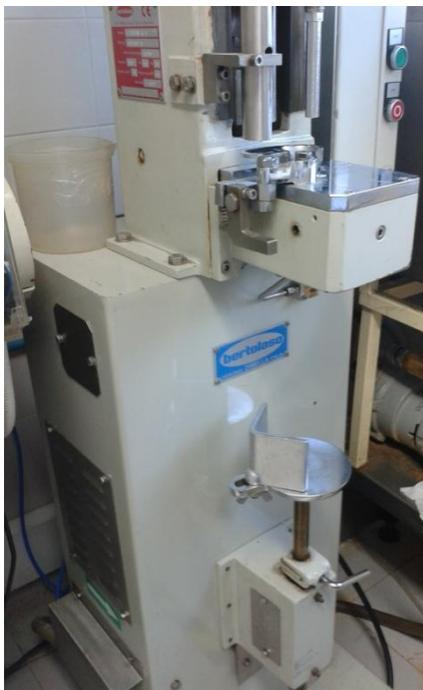
Figura 3.6 - Rolhador semi-automático utilizado.
