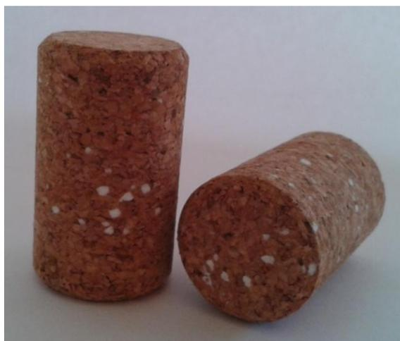
**Figura 3.9 - Rolhas contendo Octadecanamida: grânulos do *scavenger* visíveis à superfície da rolha.**
