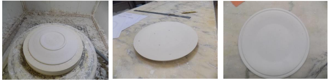
F 112 - SEQUÊNCIA DE ABERTURA DE FRETE, REMOÇÃO DO PRATO DO TORNO E ACABAMENTO
