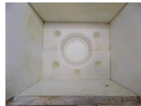
F 122 - SEGUNDA PARTE DA OBTENÇÃO DAS DUAS ÚLTIMAS PARTES DO MOLDE PARA A LEITEIRA
