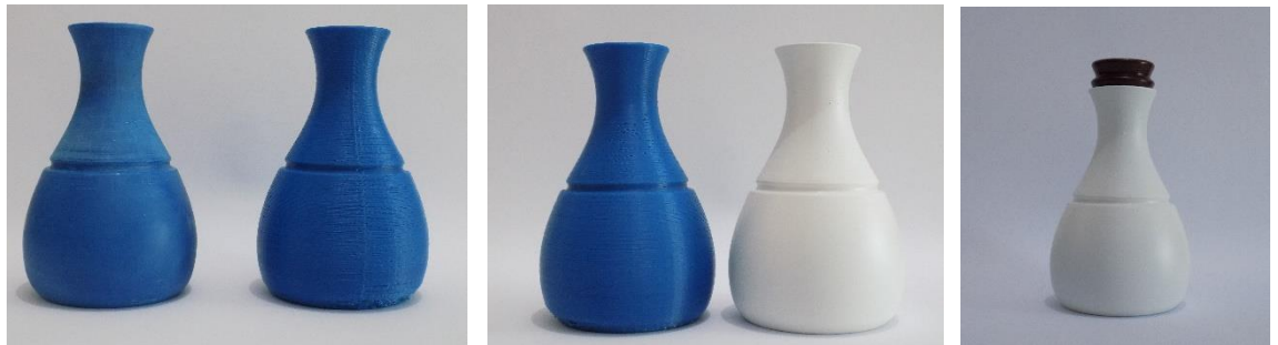
F 82 - ETAPAS DE ACABAMENTO MANUAL ATÉ OBTENÇÃO DA FINAL
