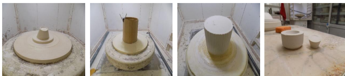
F 125 - SEQUÊNCIA DE OBTENÇÃO DO MOLDE DO MINICUP
