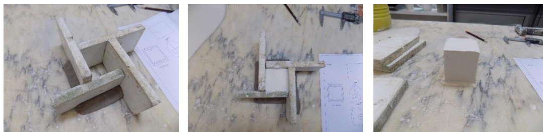
F 114 - SEQUÊNCIA DE OBTENÇÃO DO BLOCO DE GESSO PARA MODELAÇÃO
