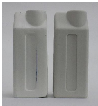
F 89 - AZEITEIRO OBTIDO POR FFF COM PROCESSAMENTO MANUAL (ESQUERDA) E AZEITEIRO EM CJP (DIREITA)
