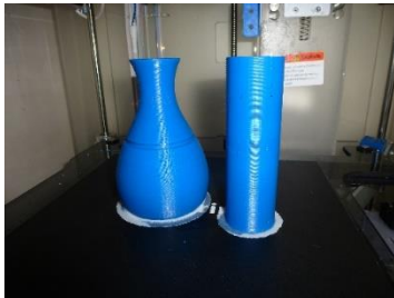
F 81 - FABRICAÇÃO DA LEITEIRA COM MATERIAL DE SUPORTE E CONSTRUÇÃO DE ESTRUTURA AUXILIAR PARA ARREFECIMENTO DAS CAMADAS DEPOSITADAS
