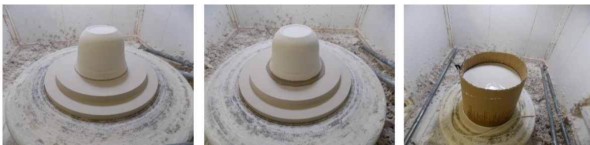
F 118 - SEQUÊNCIA DE OBTENÇÃO DO MOLDE TAÇA
