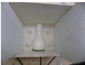
F 122 - SEGUNDA PARTE DA OBTENÇÃO DAS DUAS ÚLTIMAS PARTES DO MOLDE PARA A LEITEIRA
