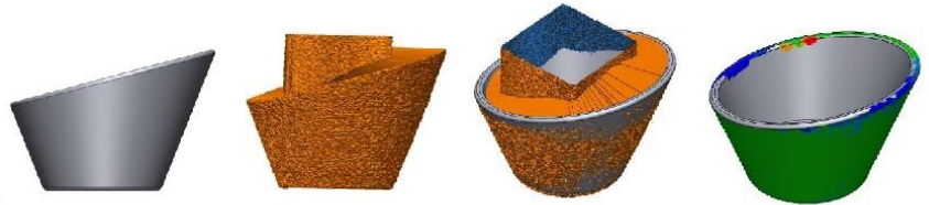
F 135 - COMPARAÇÃO MODELO DIGITAL COM MODELO IMPRESSO EM FFF - MINICUP
