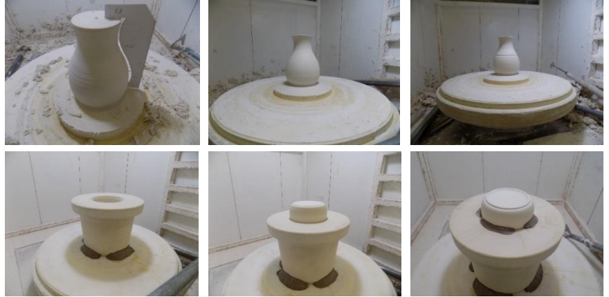
F 110 - SEQUÊNCIA DE FABRICAÇÃO DO MODELO DA LEITEIRA
