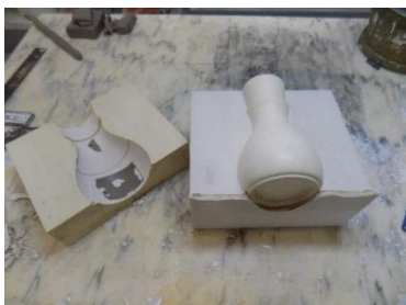
F 121 - PRIMEIRA FASE DE OBTENÇÃO DA PRIMEIRA PARTE DO MOLDE PARA A LEITEIRA
