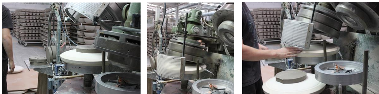
F 5 - SEQUÊNCIA DE CONFORMAÇÃO POR ROLLER EM MOLDE ABERTO E ALIMENTAÇÃO MANUAL.
