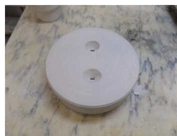
F 120 - SEQUÊNCIA DE OBTENÇÃO DO MOLDE DO PRATO
