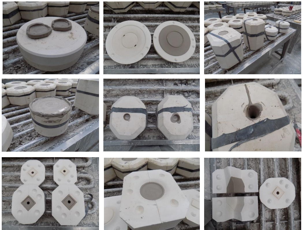
F 126 - REPRESENTAÇÃO DE ETAPAS DE OBTENÇÃO DE MODELOS
