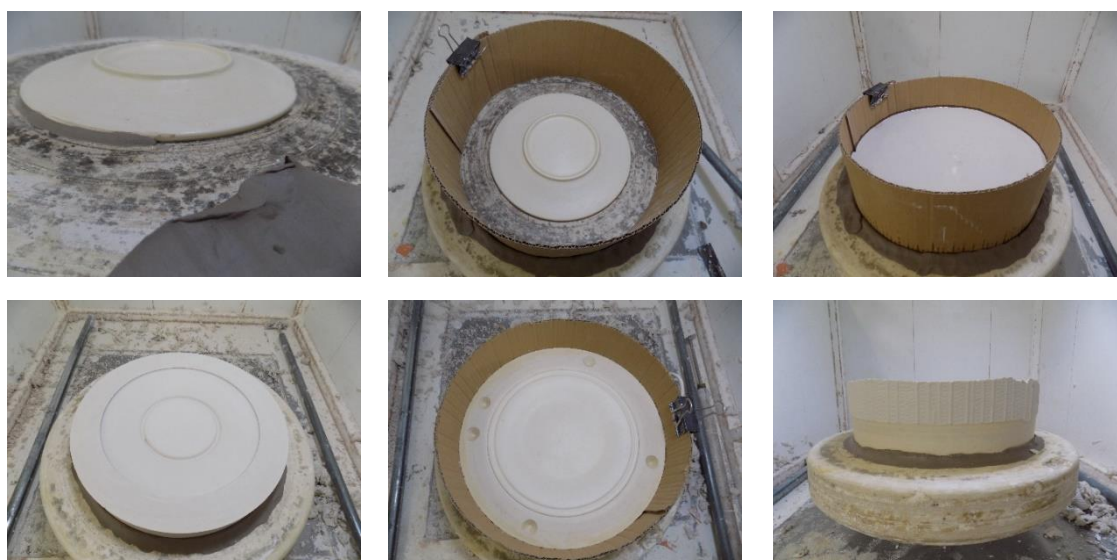
F 120 - SEQUÊNCIA DE OBTENÇÃO DO MOLDE DO PRATO
