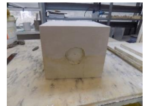
F 122 - SEGUNDA PARTE DA OBTENÇÃO DAS DUAS ÚLTIMAS PARTES DO MOLDE PARA A LEITEIRA
