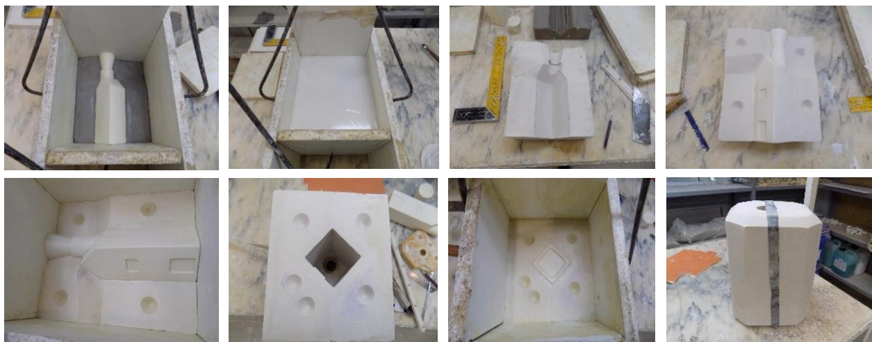
F 124 - SEQUÊNCIA DE OBTENÇÃO DO MOLDE PARA O AZEITEIRO/VINAGREIRO
