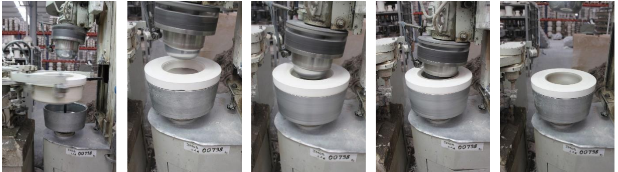
F 8 - SEQUÊNCIA DE CONFORMAÇÃO POR ROLLER EM MOLDE FECHADO E ALIMENTAÇÃO AUTOMÁTICA
