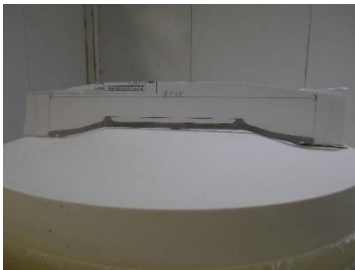
F 111 - UTILIZAÇÃO DO ESCANTILHÃO PARA PERFIL INTERIOR DO PRATO
