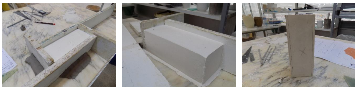
F 116- SEQUÊNCIA DE OBTENÇÃO DO PARALELEPÍPEDO DE GESSO
