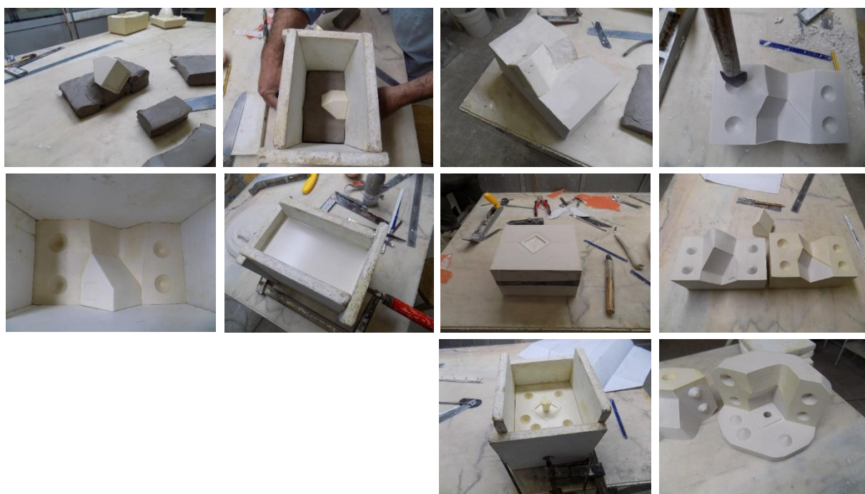
F 123 - SEQUÊNCIA DE OBTENÇÃO DO MOLDE DO PIMENTEIRO/SALEIRO
