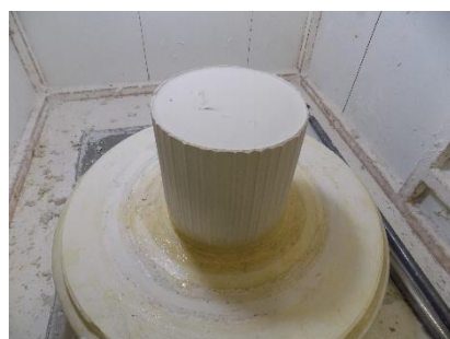
F 108 - MOLDE COM GESSO EM EXCESSO PARA INICIAR AS APROXIMAÇÕES NECESSÁRIAS
