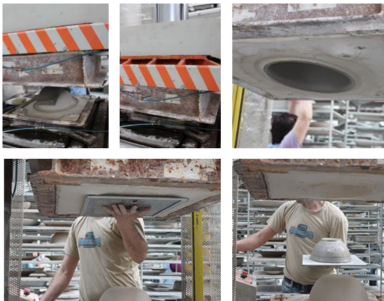
F 4 - SEQUÊNCIA DE IMAGENS DE CONFIRMAÇÃO POR Prensagem UNIAXIAL
