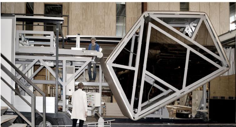
Um total de 24 camadas de fibra de cartão - com origem em árvores escandinavas - coladas entre si por um processo industrial, asseguram a resistência do material e o isolamento térmico. No fim, uma película protetora cobre o módulo exterior das intempéries e uma cobertura de ripas de madeira confere-lhe o seu aspeto final (fictionfactory, s.d.; wikkelhouse, s.d.; ciclovivo, 2016).
