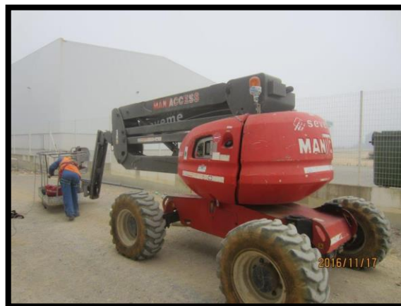
Figura 141 - Montagem do arnês para proceder à elevação da plataforma
