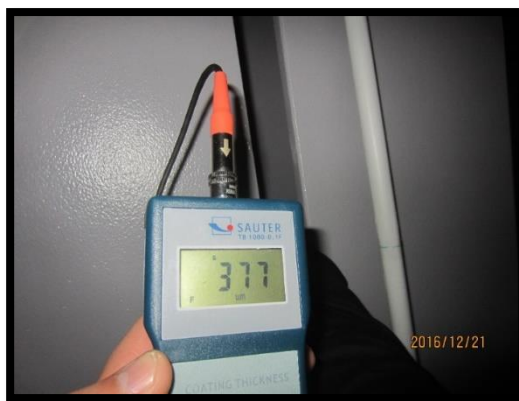
Figura 113 – Ensaio de verificação da espessura da tinta corta-fogo nos pilares metálicos com um medidor de espessuras de camadas
