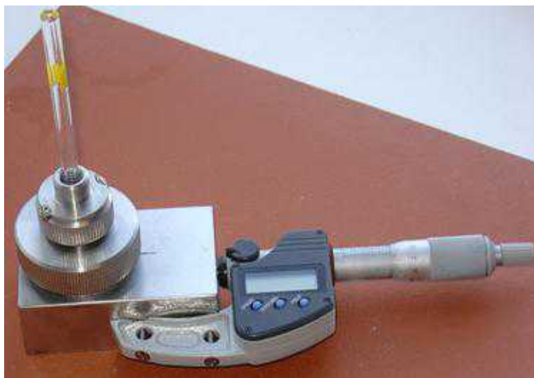
Figura 3.7 Densímetro para sólidos, concebido no laboratório de investigação do Professor José M. F. Ferreira.
