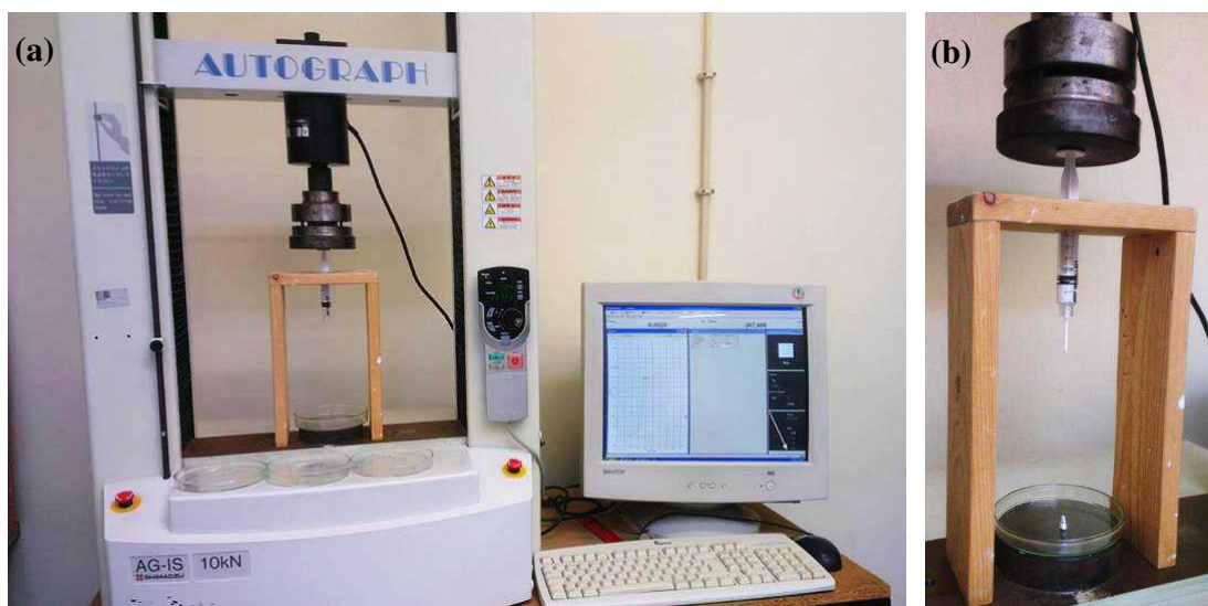
Figura 3.4 (a) Aparato utilizado nos testes de injetabilidade (Shimadzu Autograph, traezium 2, Japan); (b) dispositivo de fixação com seringa introduzida.
