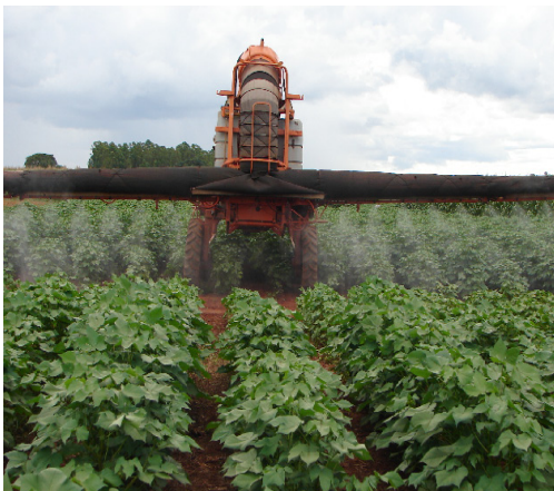
Fig. 1. Equipamento com barra com cortina de ar para arrasto das gotas de pulverização.
