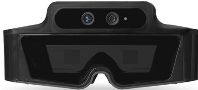
Figura 24 – Dispositivo de visualização Optical See-through - META 1 Dev. Kit
