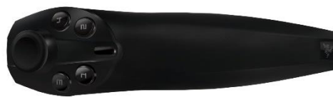
Figura 22 – Comando do Sistema de Tracking eletromagnético Razer Hydra, do qual foram retirados os sensores eletromagnéticos
