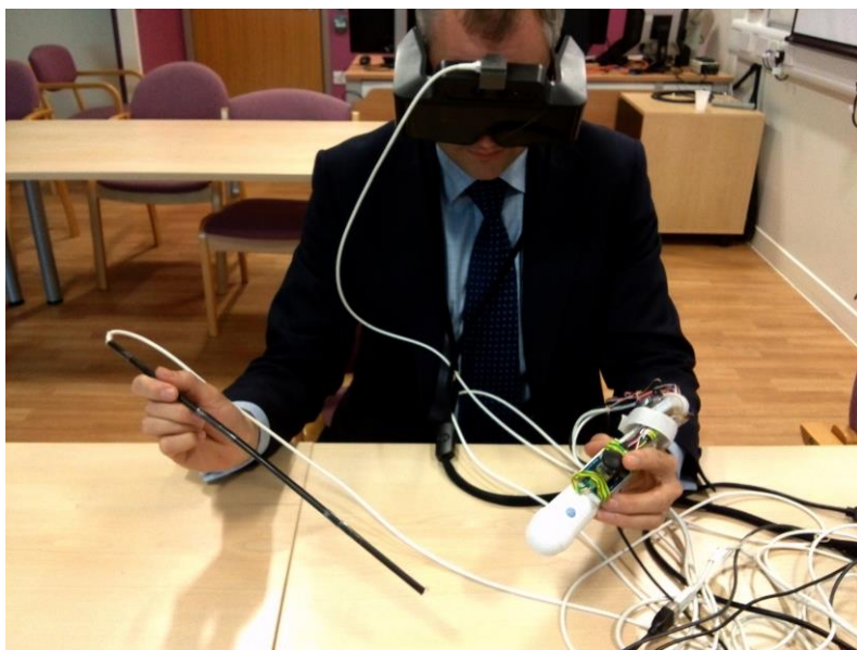
Figura 43 – Cirurgião a explorar o protótipo. Na sua mão direita segura a agulha e, na mão esquerda, a sonda de ultrassons com o respetivo módulo de interação acoplado
