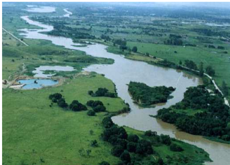
Figura 10. Alterações na geometria da seção do rio Guandu, a montante da tomada d'água da CEDAE, decorrentes da exploração inadequada de areia em cava e em leito.
