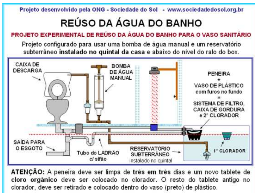
Figura 8. Esquema de técnica para reuso de água do banho. Fonte: Sociedade do Sol (2006a).
