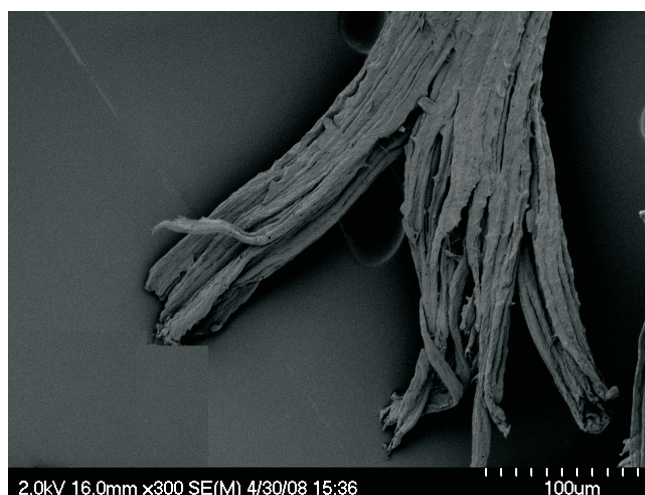
Figura 2. Microscopia eletrônica de varredura de fibra de coco imaturo.
