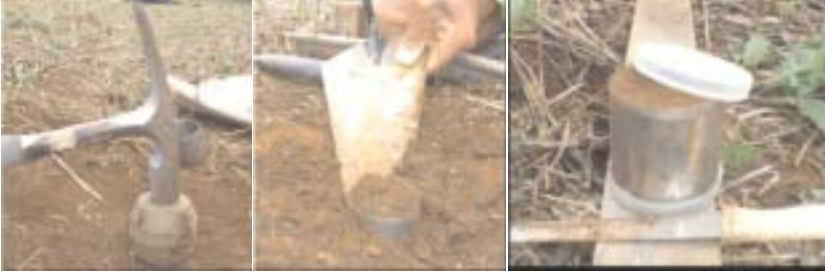
Figura 2. Procedimento utilizado na inserção (a) e na retirada (b) de amostras de solo (c) para determinação da densidade e da porosidade do solo.
