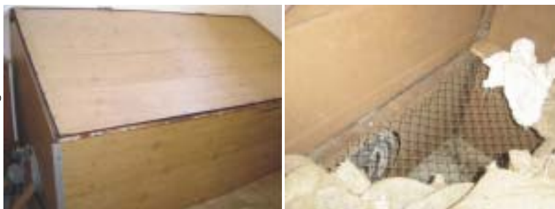
Figura 5. Exemplo de secador elétrico, construído de forma artesanal, com materiais de fácil aquisição.
