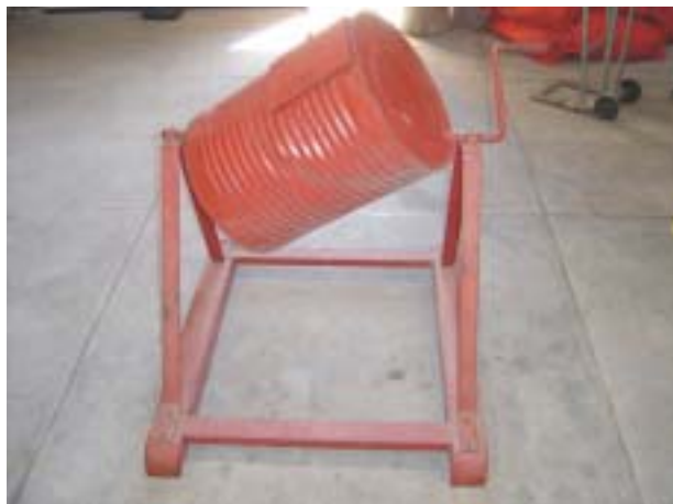
Figura 9. Tonel adaptado para tratamento de sementes.
