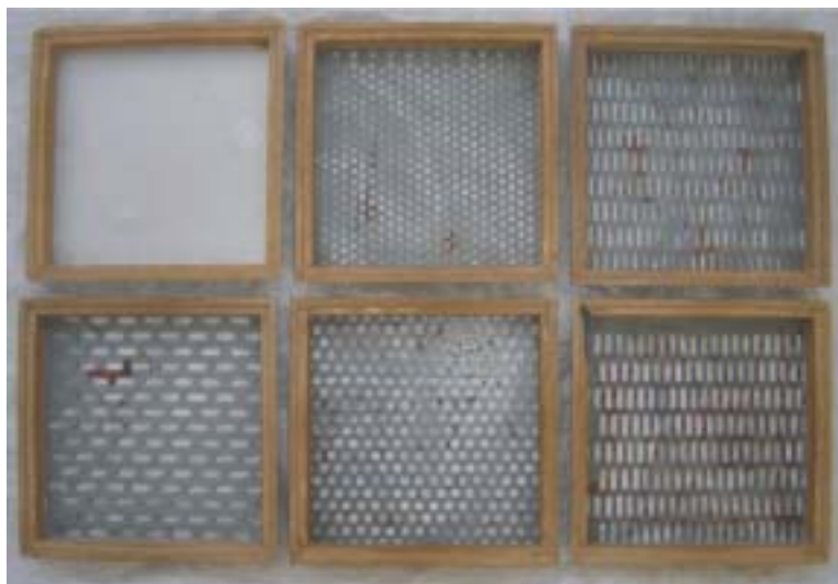
Figura 7. Peneiras para classificação de sementes de milho por tamanho e forma.
