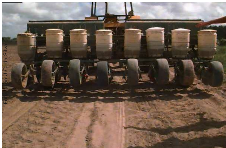
Figura 28. Regulagem das hastes da semeadeira para acompanhar o formato do camalhão. Fazenda Vale da Prata, Rio Grande, RS, 14 de dezembro de 2001.
