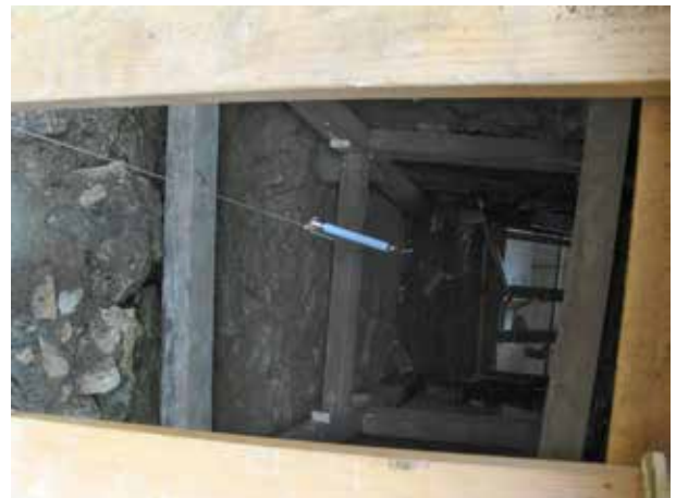
Abb. 12: Frick AG, Günsacker 2013–2014 (Fig. 013.02) – Schacht Pos. 18.19. Die Temperaturmessungen im mittleren und unteren Teil von Schacht Pos. 18.19 mithilfe von einfachen, an einer Schnur aufgehängten Thermometern.
