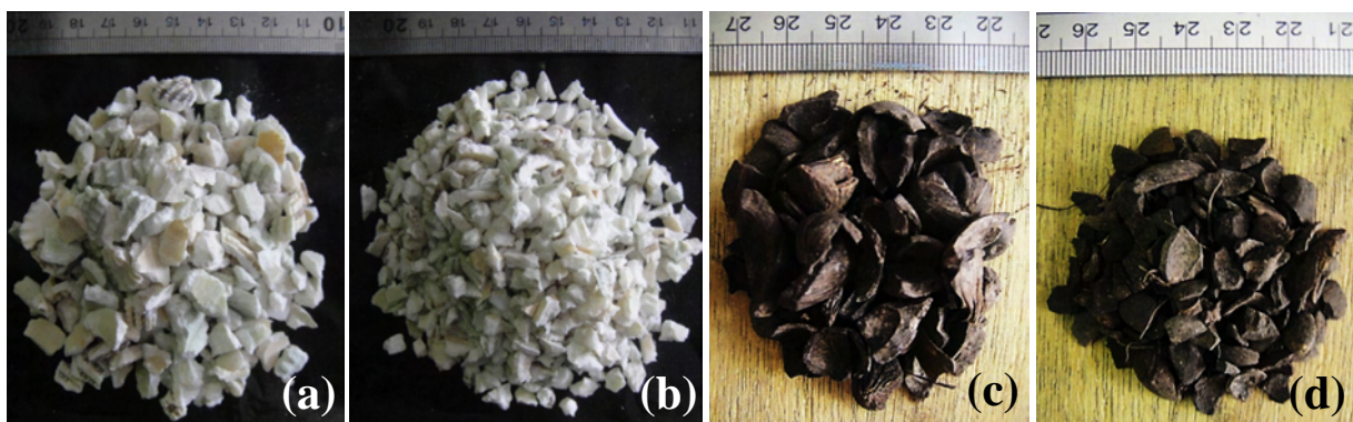
Fig. 1. Particle shapes of aggregates: (a) CS1, (b) CS2, (c) OPKS1 and (d) OPKS2.
