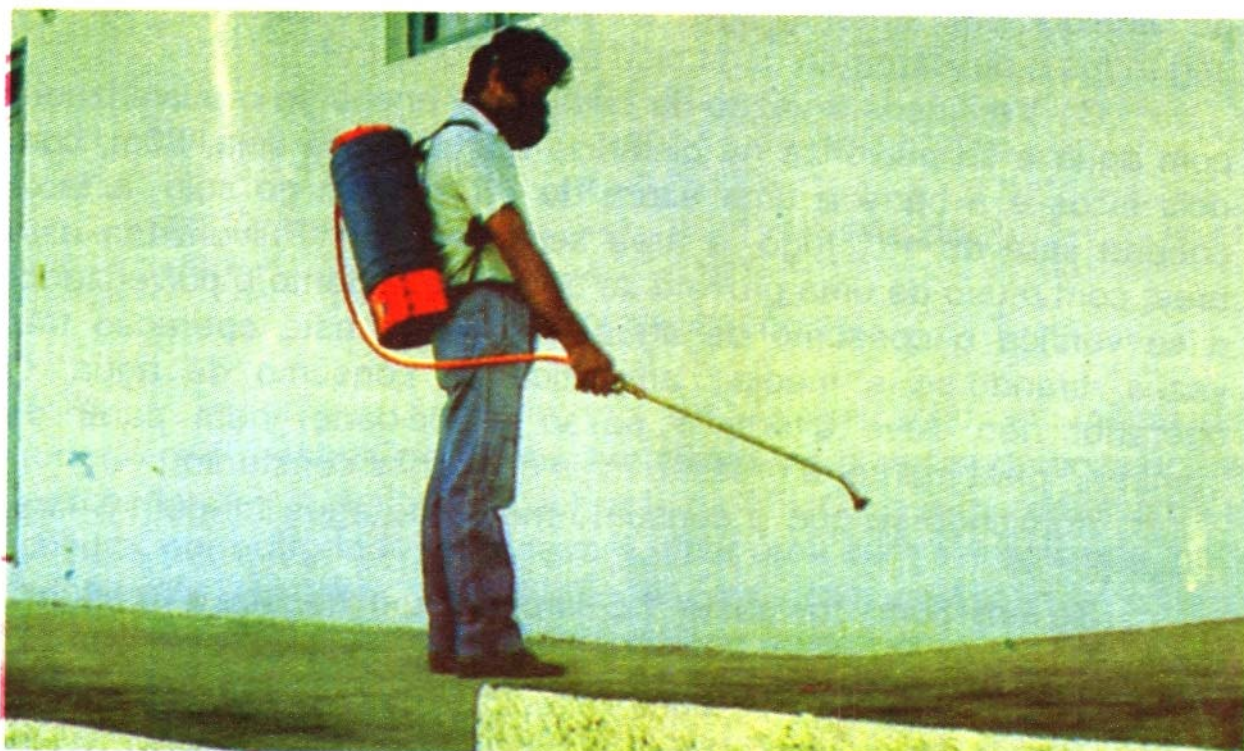
FIGURA 4. Vista geral de um pulverizador costal manual
