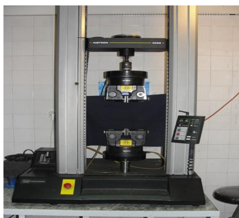
شکل ۳: دستگاه اینسترون مورد استفاده در بررسی استحکام سنجی رشته نخ‌ها Figure 3: Instron testing machine used in study strength length of yarns
