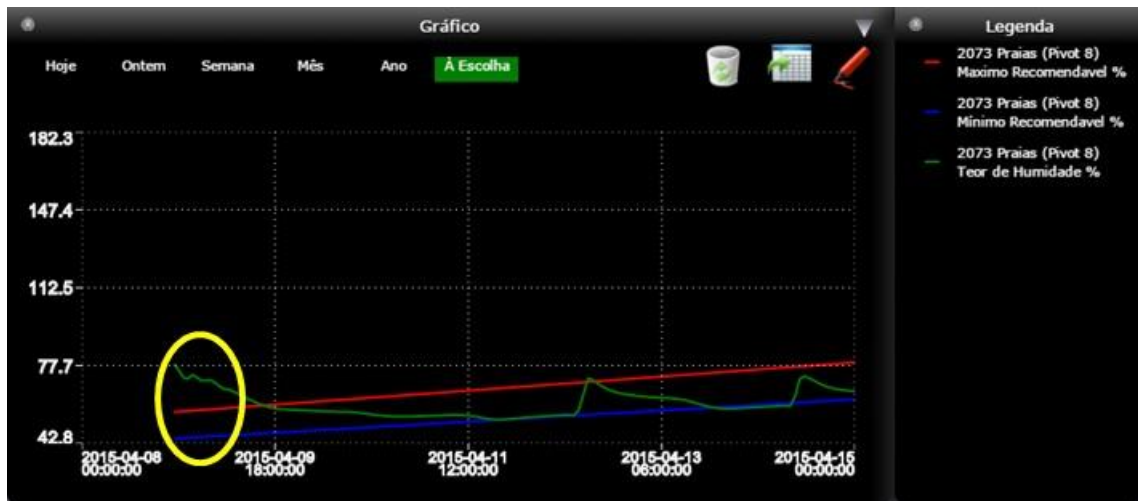
Figura 8. Observação da drenagem após instalação da sonda de humidade no solo, como estratégia para definição da linha representativa da Capacidade de Campo. Fonte: Terrapro
