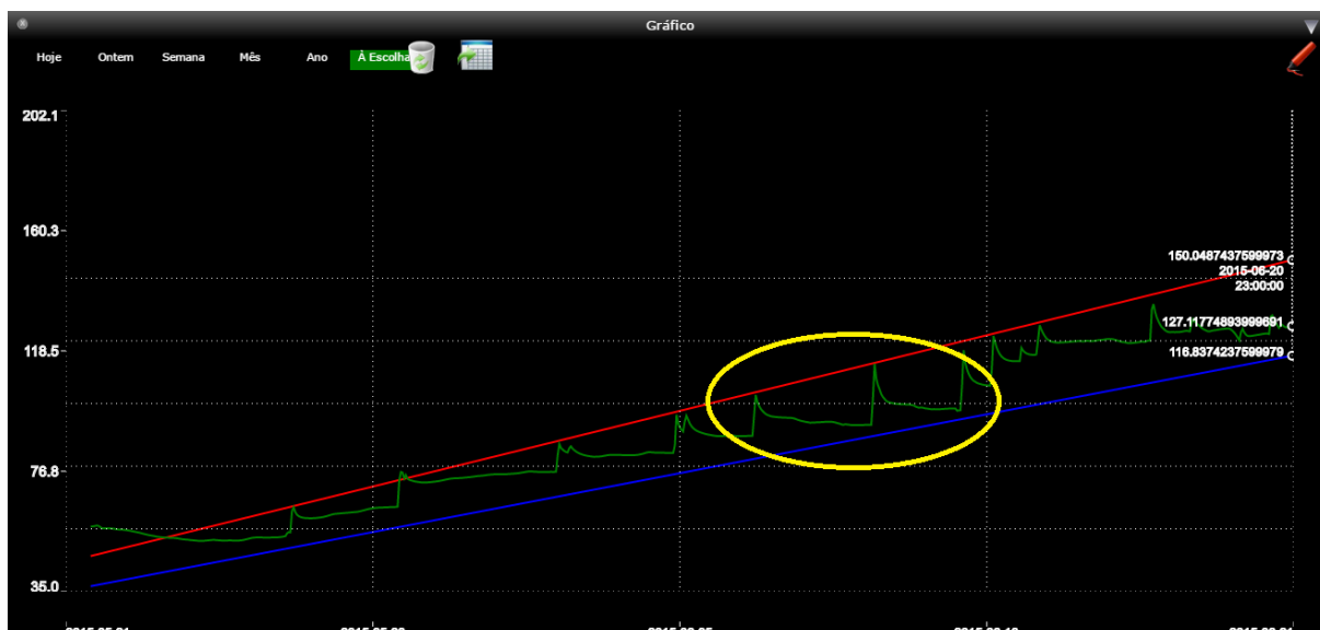
Figura 13. Representação gráfica da variação do volume de água num solo argiloso durante a campanha 2015. Intervalo entre regas evidenciado (a amarelo). Fonte: Terrapro
