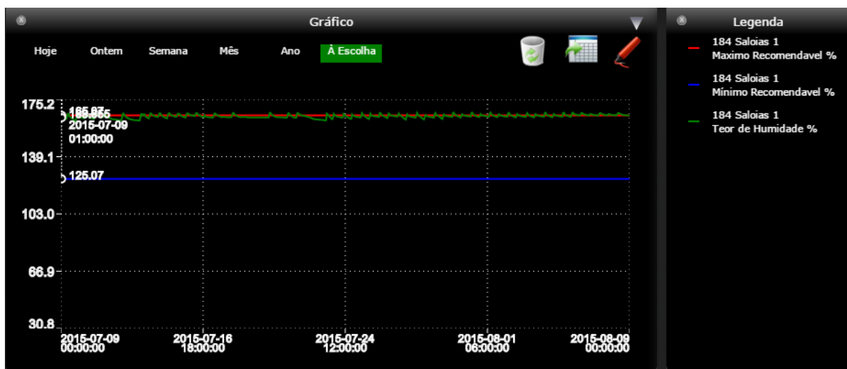
Figura 20. Representação gráfica da variação do volume de água na parcela Saloias. Exemplo de excesso de água. Fonte: Terrapro
