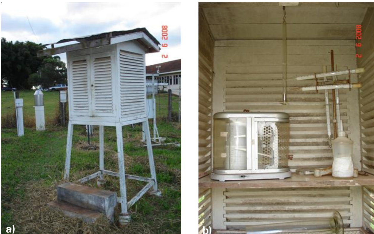
Figura 2 . (a) Abrigo meteorológico padrão; (b) Evaporímetro de Piché e demais instrumentos no abrigo.
