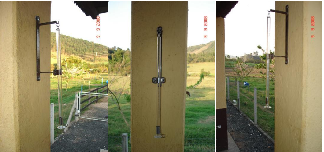
Figura 3. Vista lateral e frontal de evaporímetro de Piché em varanda de propriedade rural, exposto ao vento, mas protegido da incidência direta de luz solar.
