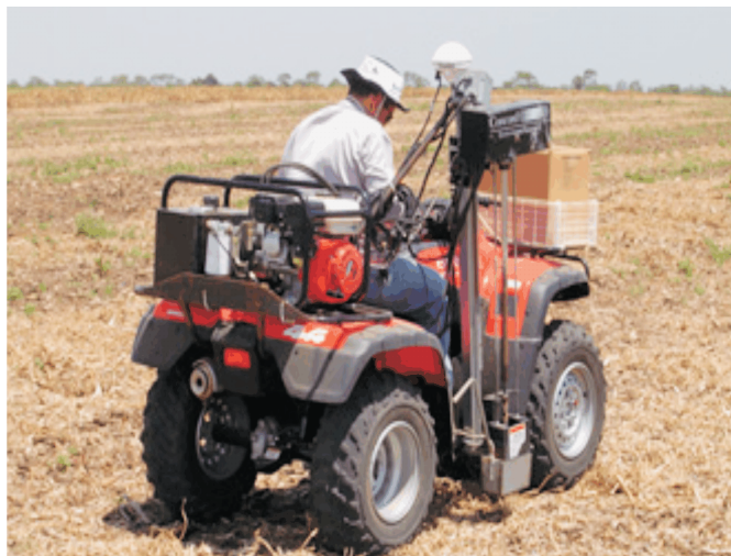
Figura 2. Quadriciclo equipado com amostrador de solo. (Foto: Bunge Fertilizantes).
