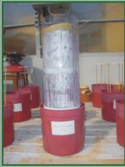
Figura 3. Coletor semi-aberto montado sobre parcela experimental.
