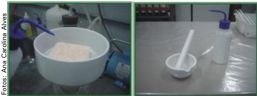
Figura 5. À esquerda, lavagem da espuma; à direita, desintegração do papel-filtro, para posterior determinação de N.
