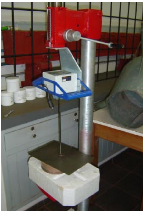
Figura 3. Equipamento de suporte ao penetrômetro de campo adaptado para uso em laboratório.
