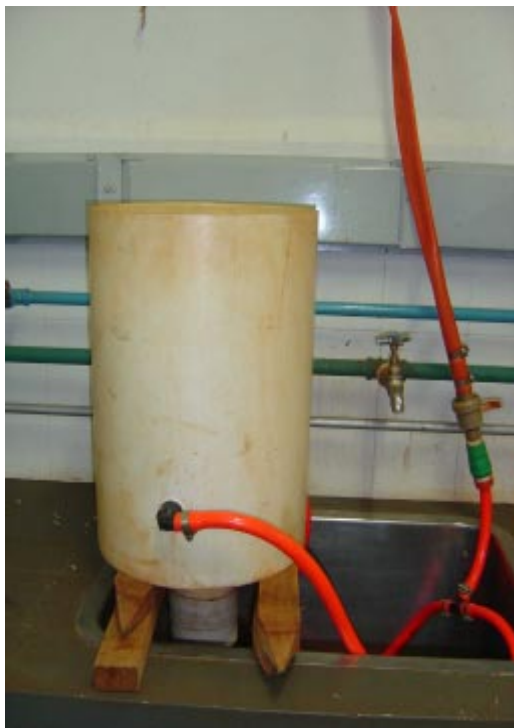
Figura 5. Equipamento construído para separar raízes das camadas de solo compactado.
