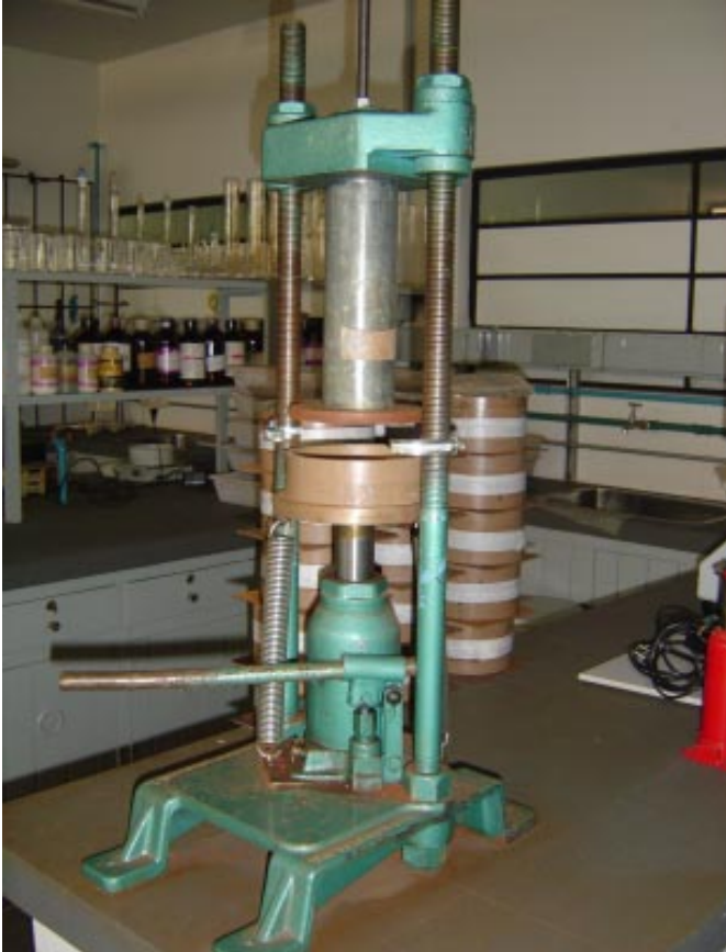
Figura 1. Prensa hidráulica com tubo de PVC posicionado para a compactação de bloco de solo.
