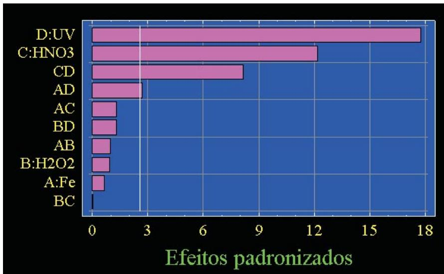
**Fig. 6.** Gráfico de Pareto para otimização da câmara fotooxidativa (II) utilizada na avaliação para o tratamento de solução carrapaticida. No eixo das abcissas, as letras referem-se a: A – ferro; B – peróxido de hidrogênio; C – ácido nítrico; D – radiação ultravioleta, respectivamente. No eixo das ordenadas, são apresentados os valores padronizados dos dados auto-escalados (ver Material e Métodos). Valores superiores a 2,8 são significativos ( $P < 0,05$ ).
