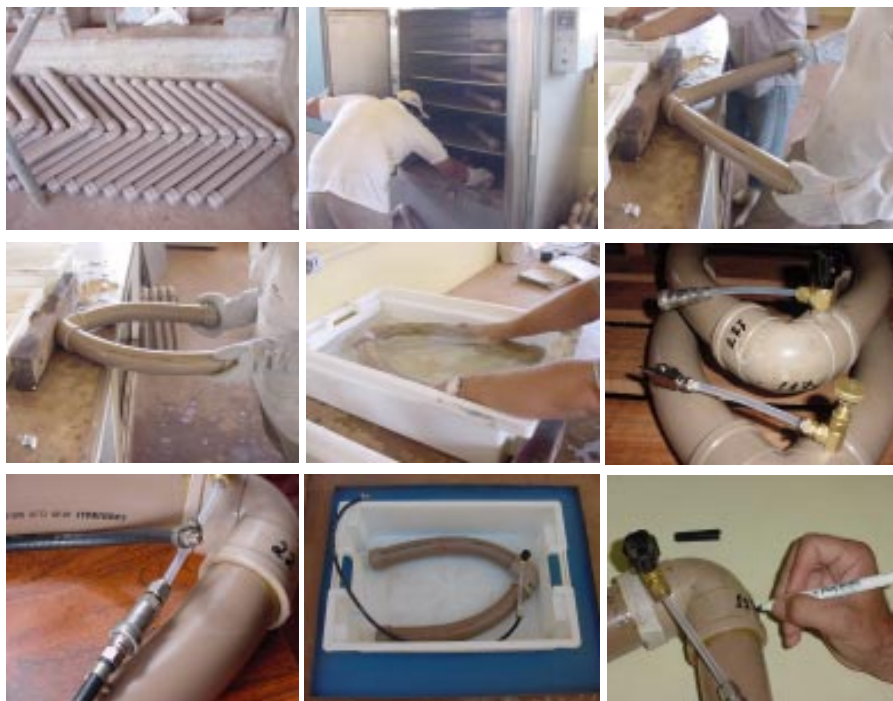
Figura 4. Construção da canga: a) peças coladas de tubo, tampas e cotovelo de PVC; b) verificação do ponto de maleabilidade do PVC na estufa; c-d) moldagem da canga; e) esfriamento da canga, para estabilizar a forma; f) válvula de coleta + engate rápido americano (acima) e nacional (abaixo) montado na canga; g) detalhe de válvula de câmara de ar de pneu de caminhão conectado por engate rápido à canga, para teste de vazamento ou borbulhamento; h) teste de vazamento da canga completa com ar comprimido; i) identificação.
