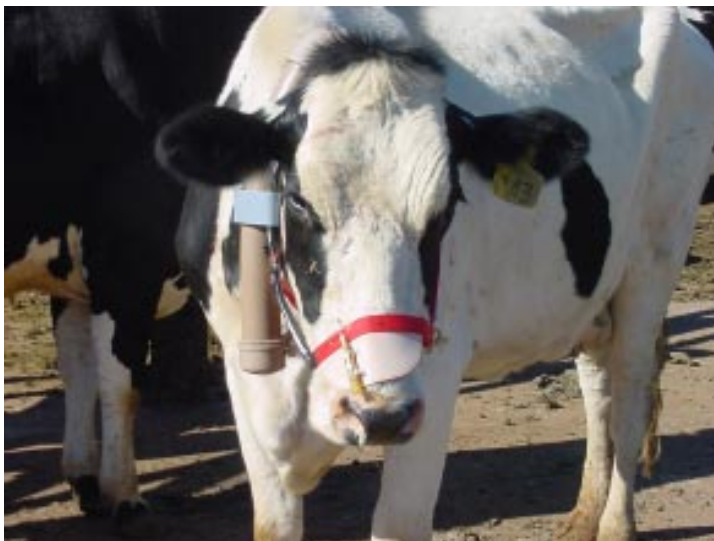
Figura 1. Animal com cabresto coletor e canga armazenadora.
