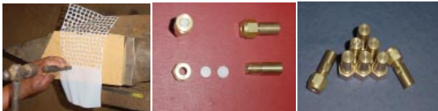
Figura 2. Etapas de preparação da cápsula de permeação: a) estampando discos de PTFE; b) acima: cápsula de permeação montada, de pé e deitada; abaixo: porca de conexão, pastilha porosa (frita), disco de PTFE e corpo da cápsula de permeação; c) número na cápsula de permeação.
