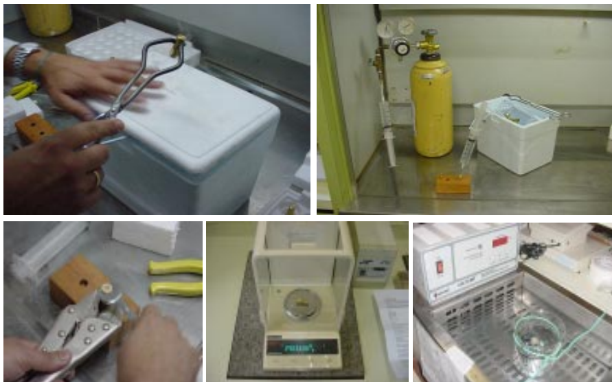
Figura 3. Carga e calibração da cápsula de permeação: a) eliminação do N 2 residual da cápsula; b) carga da seringa com SF 6 (esquerda) e descarga na cápsula (meio), ao lado caixa de poliestireno com N 2 (direita), telado com cápsulas resfriadas e pinça; c) aperto final da porca da cápsula carregada; d) pesagem da cápsula carregada e seca, após atingir temperatura ambiente; e) manutenção das cápsulas em banho-maria a 39°C, para posterior determinação da taxa de emissão de SF 6 .
