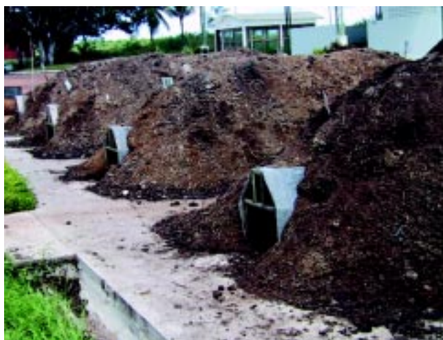
Conjunto de leira estática na fase de bioestabilização.
