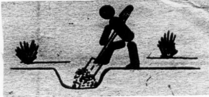
Fig. 6. Em seguida, com a pá reta, acertar uma das paredes laterais, jogando para fora a terra do acerto. Feito isto, retirar uma fatia de terra dessa parede, cortando com a pá reta até o fundo da cova.
