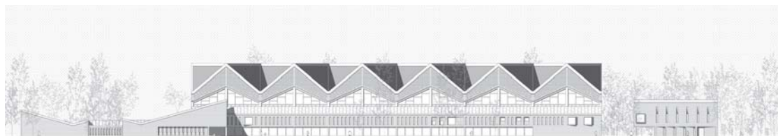
ACTIVATING THE PERIPHERY – Huang A., Taylor C.; Area 11.500 mq; Acciaio 117 kg/mq + Calcestruzzo 188 kg/mq; Fabbisogno energetico annuo 90 kWh/mq.
