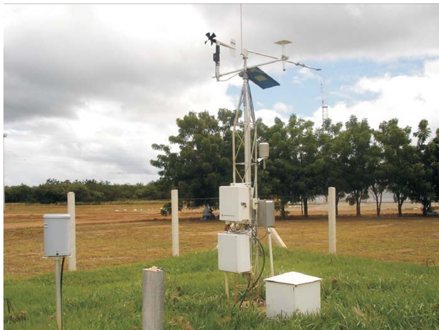
Fig. 2. Estação Agrometeorológica Automática instalada na Fazenda Brasil Uvas, Juazeiro-BA.
