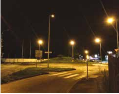
2A e 2B. Intervento in un comune della Provincia di Milano, sono state sostituite le lampade a vapori di sodio da 250 W (2A) con lampade a induzione da 120 W (2B): si è riscontrato un risparmio pari al 65% e un evidente aumento dell'illuminazione stradale
