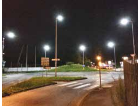
2A e 2B. Intervento in un comune della Provincia di Milano, sono state sostituite le lampade a vapori di sodio da 250 W (2A) con lampade a induzione da 120 W (2B): si è riscontrato un risparmio pari al 65% e un evidente aumento dell'illuminazione stradale
