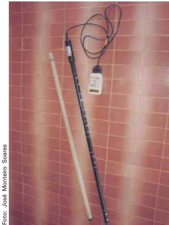
Fig. 10. Detalhes do FDR portátil utilizado no monitoramento do conteúdo de água no solo, Petrolina-PE.
