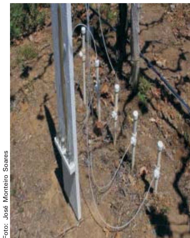
Fig. 11. Detalhes de equipamentos utilizados no monitoramento do conteúdo de água no solo: a) Tensiômetros de mercúrio; b) Tensímetro, Petrolina – PE.
