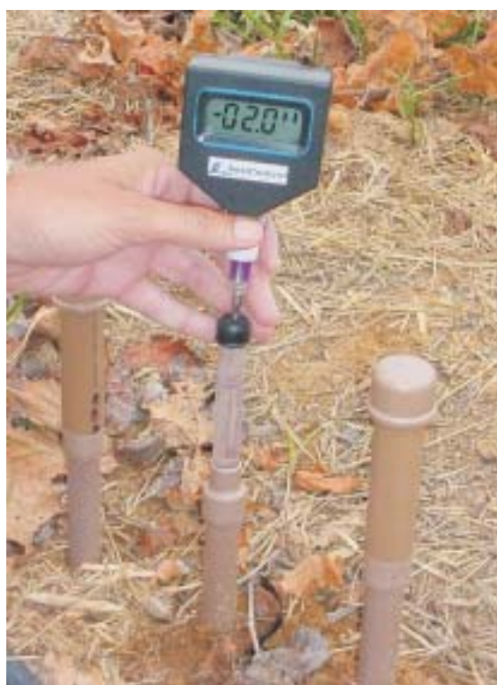
Fig. 11. Detalhes de equipamentos utilizados no monitoramento do conteúdo de água no solo: a) Tensiômetros de mercúrio; b) Tensímetro, Petrolina – PE.
