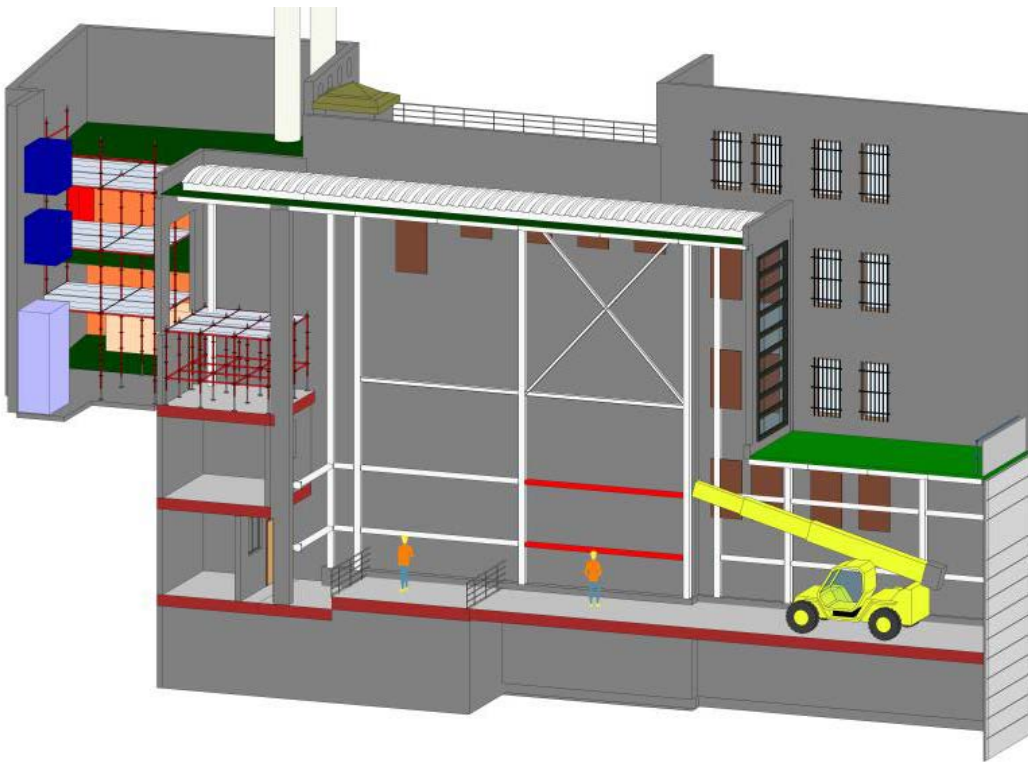
Figura 3. Modello ergotecnico allo stadio di progettazione. Fase di montaggio della carpenteria metallica.
