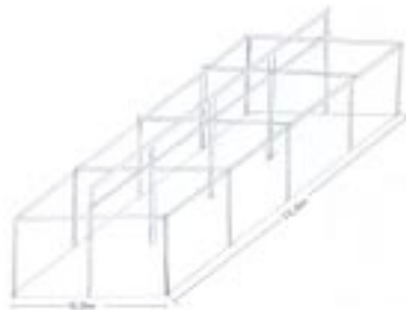
Figura 3. Estrutura do viveiro telado com madeira serrada, tipo capela, antes de colocar a estrutura do teto.
