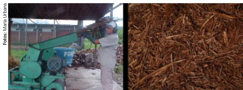
Figura 3. Trituração da casca de coco seco
