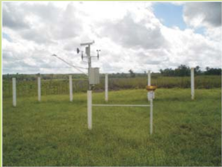
Fig. 1. Estação agrometeorológica automática instalada na Embrapa Meio-Norte.
