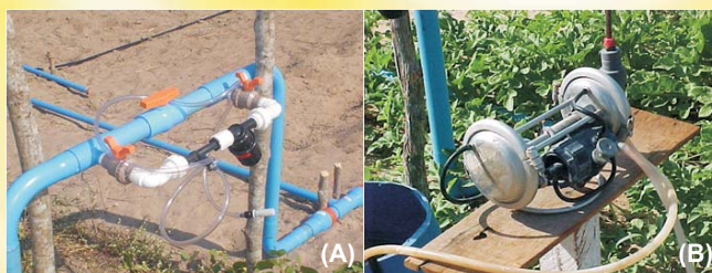
Fig. 3. Equipamentos usados para a injeção dos fertilizantes (A - injetor venturi; B - bomba hidráulica TMB).
