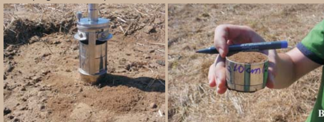
Fig. 3. Procedimento de coleta da amostra indeformada (A - trado para coleta de amostras indeformadas em anéis cilíndricos; B - amostra coletada).
