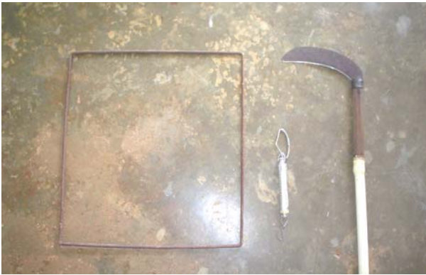
Fig. 1. Instrumentos utilizados no método direto. Da esquerda para direita: moldura de ferro, balança portátil e cutelo.
