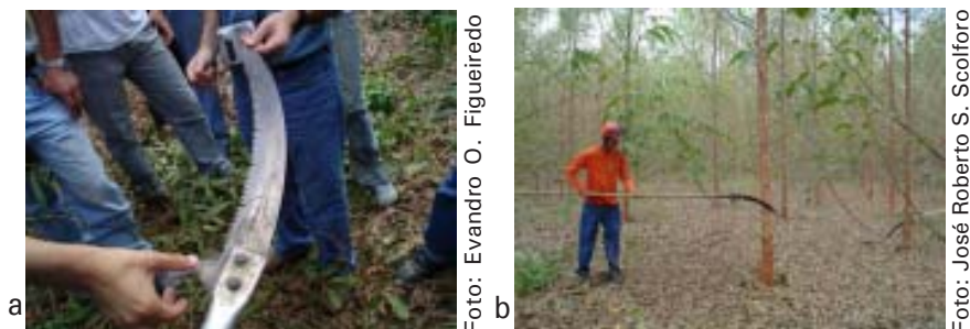
Fig. 9. Detalhe do serrote para operação de desrama (a); atividade de desrama realizada com serrote de poda florestal (b).
