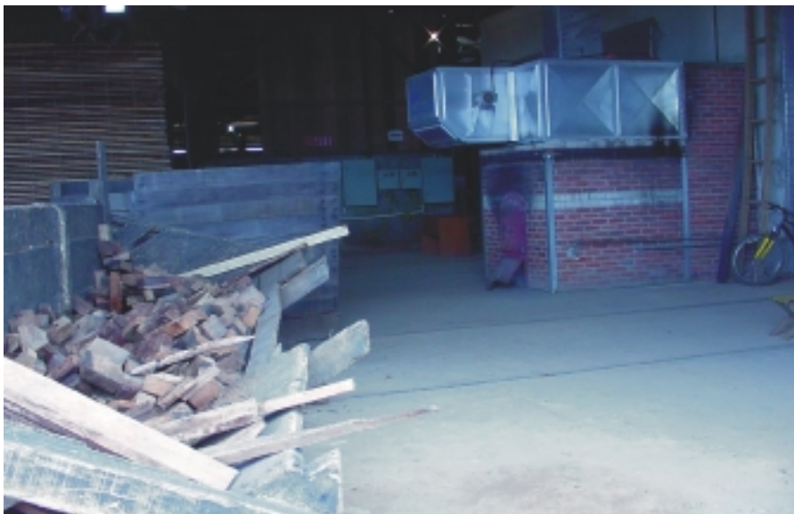
Fig. 9. Aproveitamento de resíduos do tipo pontas/aparas/peças defeituosas na fornalha de uma estufa de secagem de madeira convencional.
