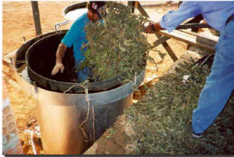
FIG. 1 . Extrator de óleo essencial de pimenta longa
