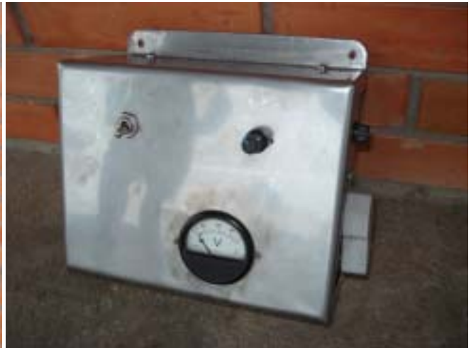
Regulador de voltagem.
