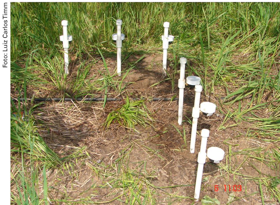
Figura 1. Bateria de tensiômetros para monitorar a tensão da água no solo e o manejo da irrigação.
