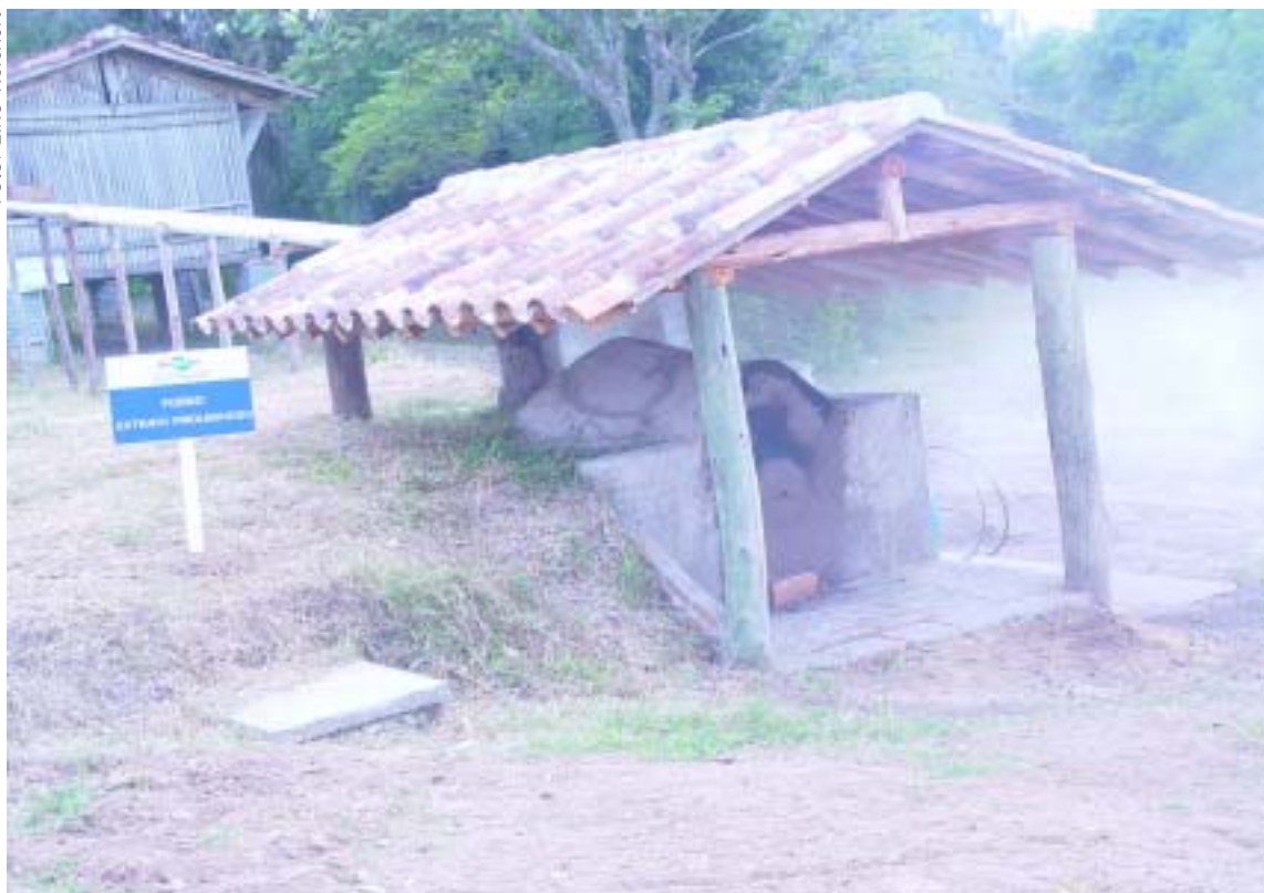
Figura 4. Vista de um forno adaptado para a coleta de extrato pirolenhoso, construído na Estação Experimental da Cascata - Embrapa Clima Temperado pelo prof. Newton S. Miyasaka.
